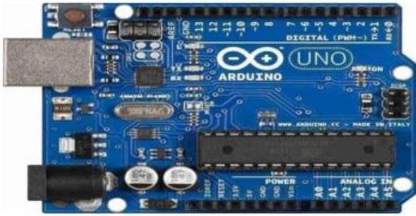
Fig 2:- Arduino UNO (Atmega 328)
