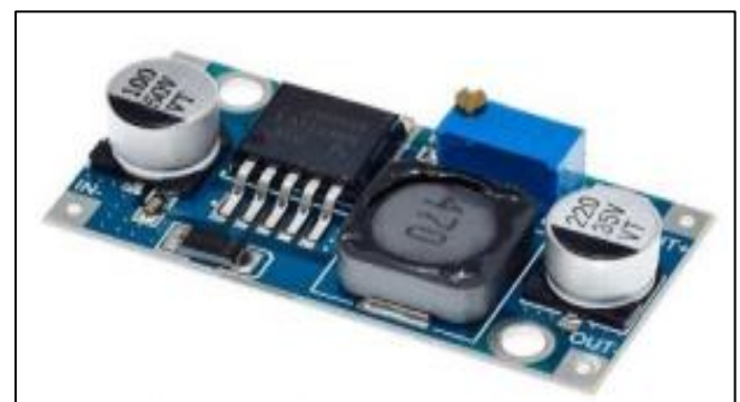
Fig 6 LM2596 Modulo Dc-Dc
