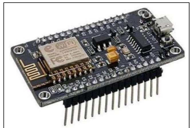
Fig 2 MCU Node ESP8266 Wi fi Module
