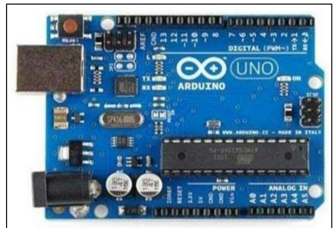
Fig 1 Arduino UNO R3(ATMEGA328P)
