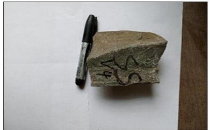
Fig 6a: Echantillon De Calcaire Massif De Couleur Grise
