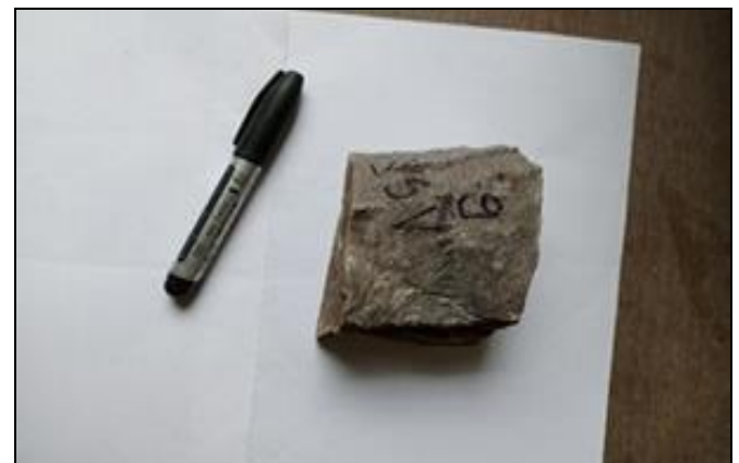
Fig 11a: Echantillon De Shales à Litage Planaire De Shales à Grains Fins De Couleur Rouge.
