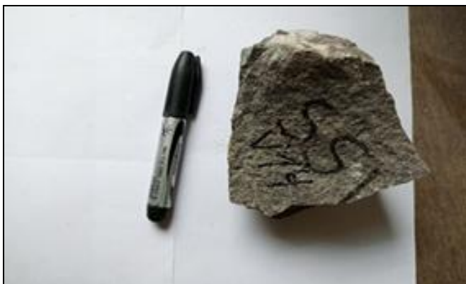
Fig 8a: Echantillon De Calcaire à Litage Planaire De Couleur Grise.
