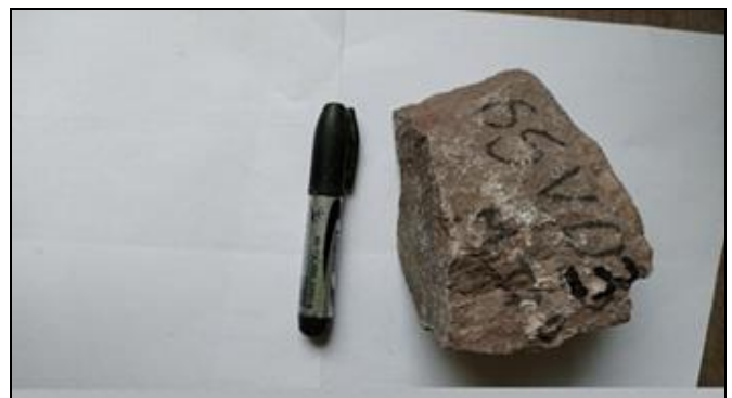
Fig 9a: Echantillon D'un Shale à Grains Très Fins De Couleur Rouge.
