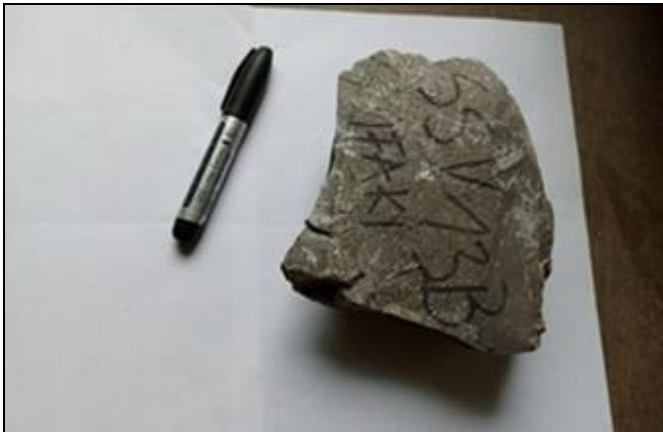
Fig 7a: Echantillon De Calcaire à Litage Lenticulaire De Couleur Grise.
