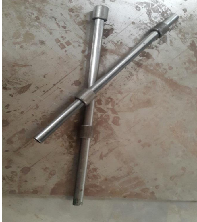
Fig 3.2 Guide rod & bush
