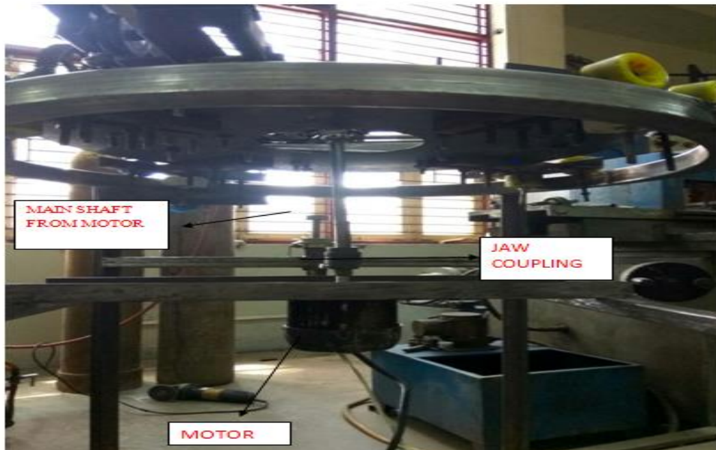
Fig 7:- Actual Frame With Motor
